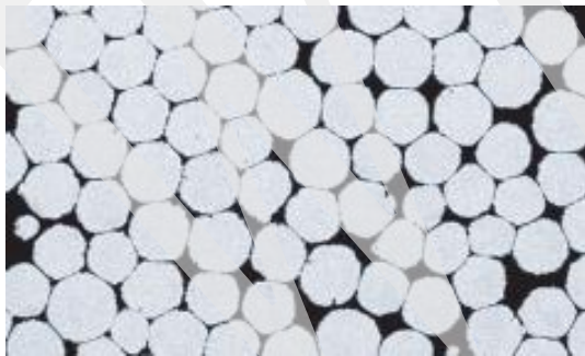
AMtrinsic®球形 Nb 的抛光截面的 SEM 显示致密的形态，没有空洞或裂纹。
